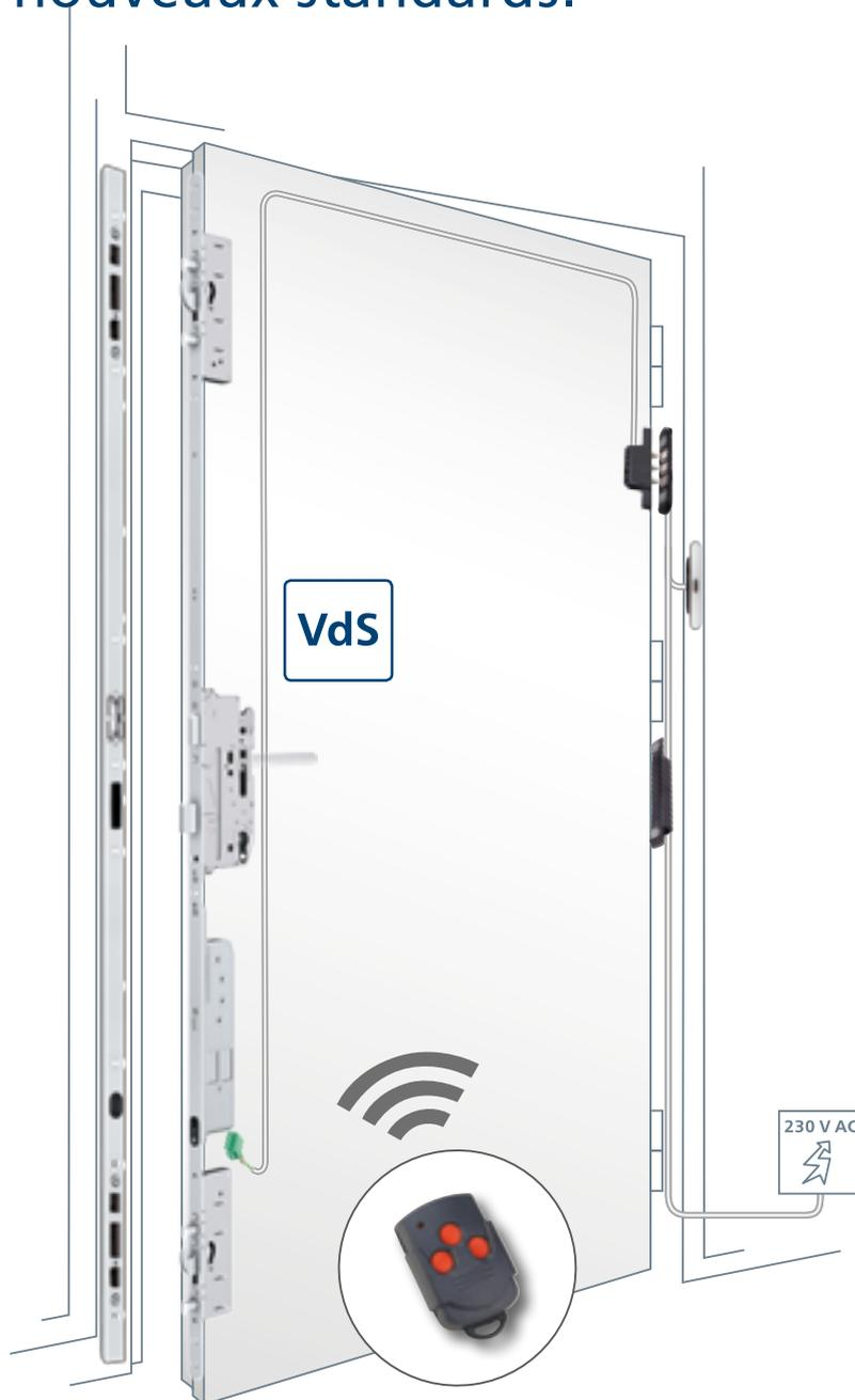
La version standard inclue tous les composants pré-branchés dans un kit. La porte n'a plus qu'à être posée et branchée au secteur 230-V.
